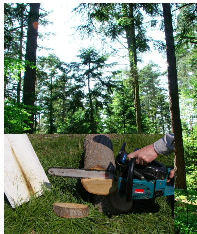
Ciecie drewna łańcuchową piłą motorową z widoczną na ekranie płamą wyrzucanego z niej oleju do środowiska
